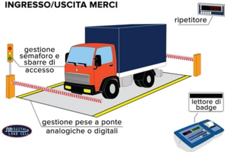
Software particolarmente indicato nella pesatura di veicoli e gestione di pese a ponte, con controllo ingresso/uscita merci. La versione AF03 permette la pesatura dell'automezzo singolo o con rimorchio, sia con operatore che self-service con lettore di badge, gestione avanzata di dati e stampe. AF03 offre inoltre la possibilità di gestire le principali celle di carico digitali disponibili sul mercato. Omologabile CE-M (OIML R-76 / EN 45501).
