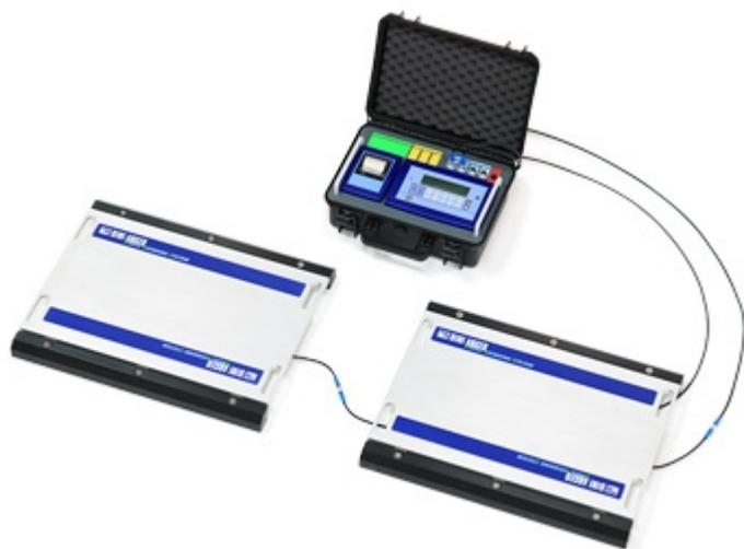
**Kit specifico per la pesatura assi manuale statica**, composto da due piattaforme portatili e dal terminale di pesatura con stampante. Lo scontrino riporta tutti i dati di pesata, per successiva archiviazione e tracciabilità.
