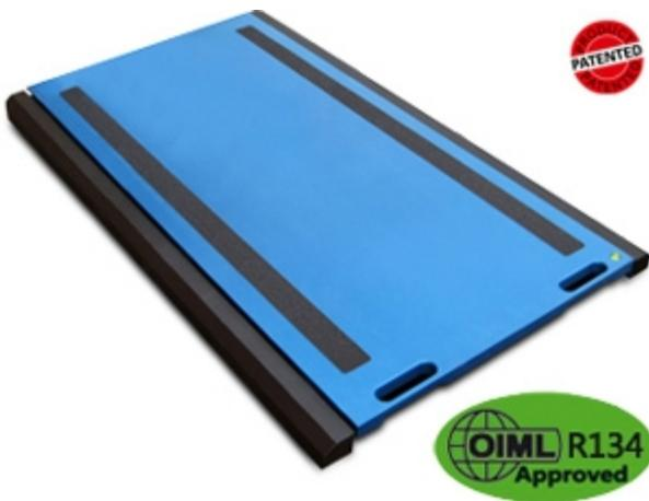
Piattaforme progettate per la realizzazione di stazioni pesa ruote e assi per veicoli di grandi dimensioni, dotati di ruote gemellate o pneumatici di grandi dimensioni (autotreni, autoarticolati, TIR, veicoli da cantiere etc.); munite di ruote integrate e maniglie per agevolarne il trasporto e il posizionamento. Particolarmente indicate per la pesatura dinamica.
