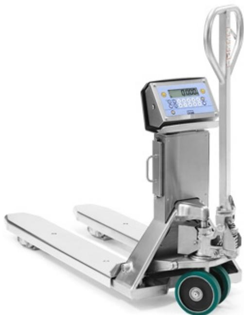
Transpallet con pesatura elettronica integrata per aree pericolose, classificate a rischio di esplosione (ZONE 1 e 21 & 2 e 22) con modo di protezione secondo Ex II 2GD IIB T4 T197°C X. Il rilevamento del peso a 4 celle di carico inox IP68, certificate ATEX, garantisce la massima precisione in ogni condizione di lavoro. Struttura completamente in acciaio INOX. Disponibili anche in versione OMOLOGATA CE-M.
