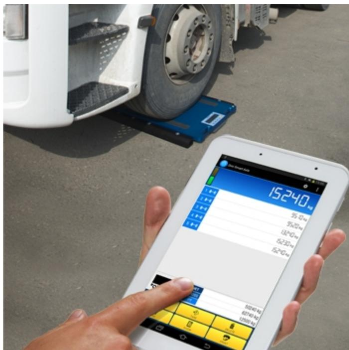
DINI SMART AXLE è un software specifico per funzionamento su tablet/smartphone, da abbinare a bilance pesa assi WWS, che permette di pesare in modo semplice e rapido veicoli di ogni tipologia, condividendo i dati in tempo reale con il sistema informatico aziendale. Il programma offre numerose funzionalità di registrazione e condivisione delle pesate, via ftp, e-mail o altri programmi di scambio dei dati.
